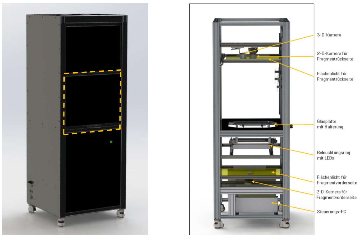
Abbildung 10: Außenansicht des 2,5-D-Scanners; links: CAD-Modell mit Umhausung; rechts: Systemkomponenten [orange Markierung: Hubtür zum Öffnen und Schließen des Scanners]
