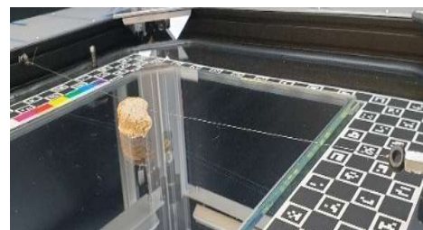
Abbildung 11: Innenansicht des 2,5-D-Scanners; links: Aufnahmebereich; rechts: Stabilisierungsvorrichtung © MusterFabrik Berlin
